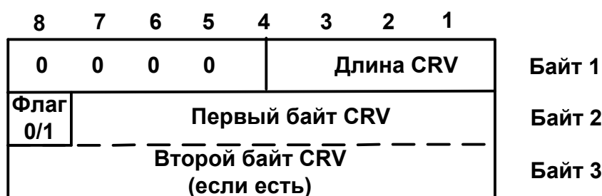
Рисунок 39 – Формат информационного элемента “CRV”
