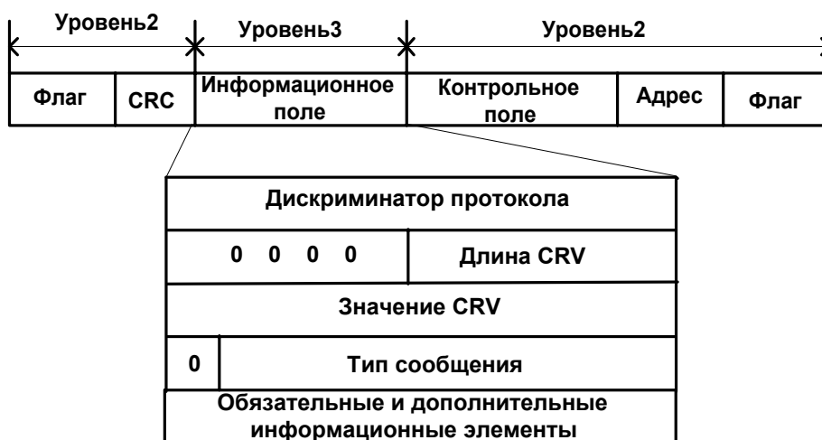
Рисунок 38 – Структура цикла LAPD с информационным полем
